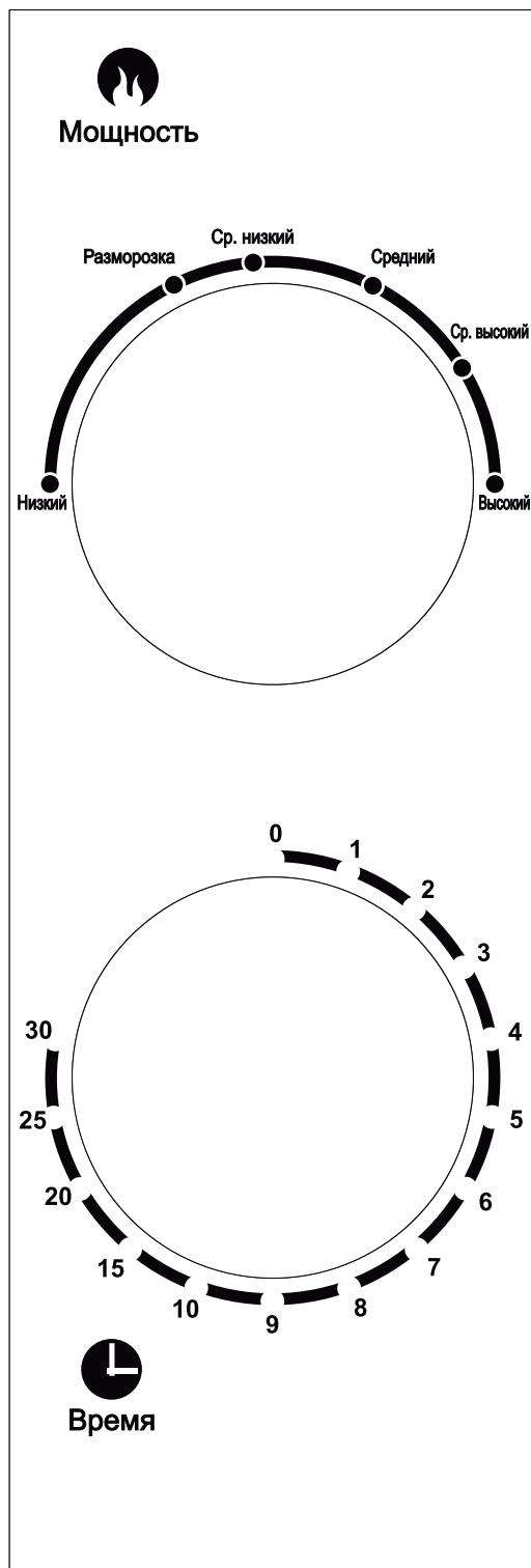
На панели управления имеются две ручки, одна из которых – установка уровня мощности (вверху), и вторая – установка времени (внизу).
