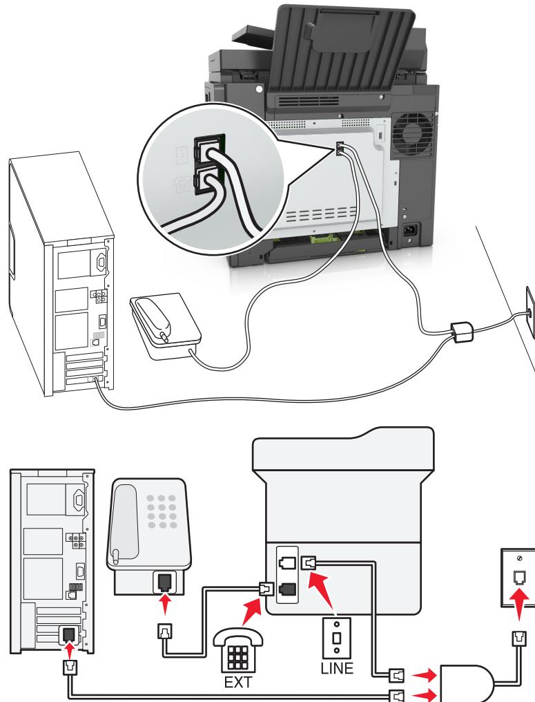
Линия DSL разделяет обычную телефонную линию на два канала: голосовой и Интернет. Сигналы телефона и факса передаются по голосовому каналу, а сигналы Интернета – по другому. Таким образом одну линию можно использовать для аналоговых голосовых вызовов (включая факсы) и для цифрового доступа в Интернет.
