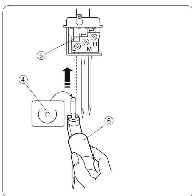
Вставьте новую иглу в отверстие иглодержателя плоской стороной назад, подтолкните иглу вверх к стопору. Затем затяните винт.
