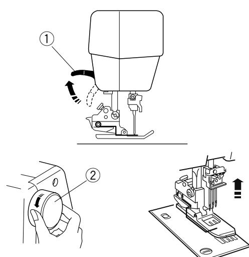
Поднимите рычаг прижимной лапки.
